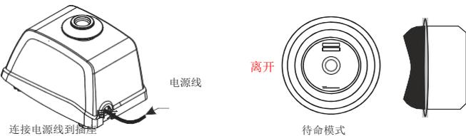
连接涡旋混合器后侧的电源适配器，如上图所示。
