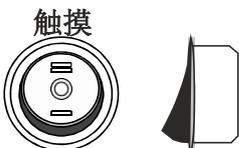
按3路开关向下向“ON”侧，以启用连续模式。在连续模式下，涡旋动作将在设定的速度和时间自动启动（不按杯头）。下面是摇杆开关的位置，显示涡旋混合器在连续模式下。
